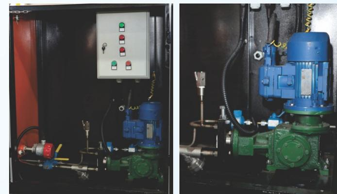
**Оборудование предназначено для измерения среднесуточной массы жидкости и объема газа, для определения среднесуточной массы нефти, добываемых из нефтяных скважин.**
